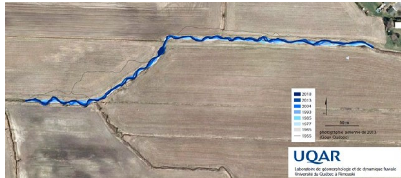
Figure 2. Déplacement de la rivière aux Ormes depuis 1955. Entre 2004 et 2015, l'érosion moyenne au-delà du haut du talus est de 12,5 m 2 /année, répartie dans 6 principaux foyers d'érosion sur une distance de 500 mètres.
